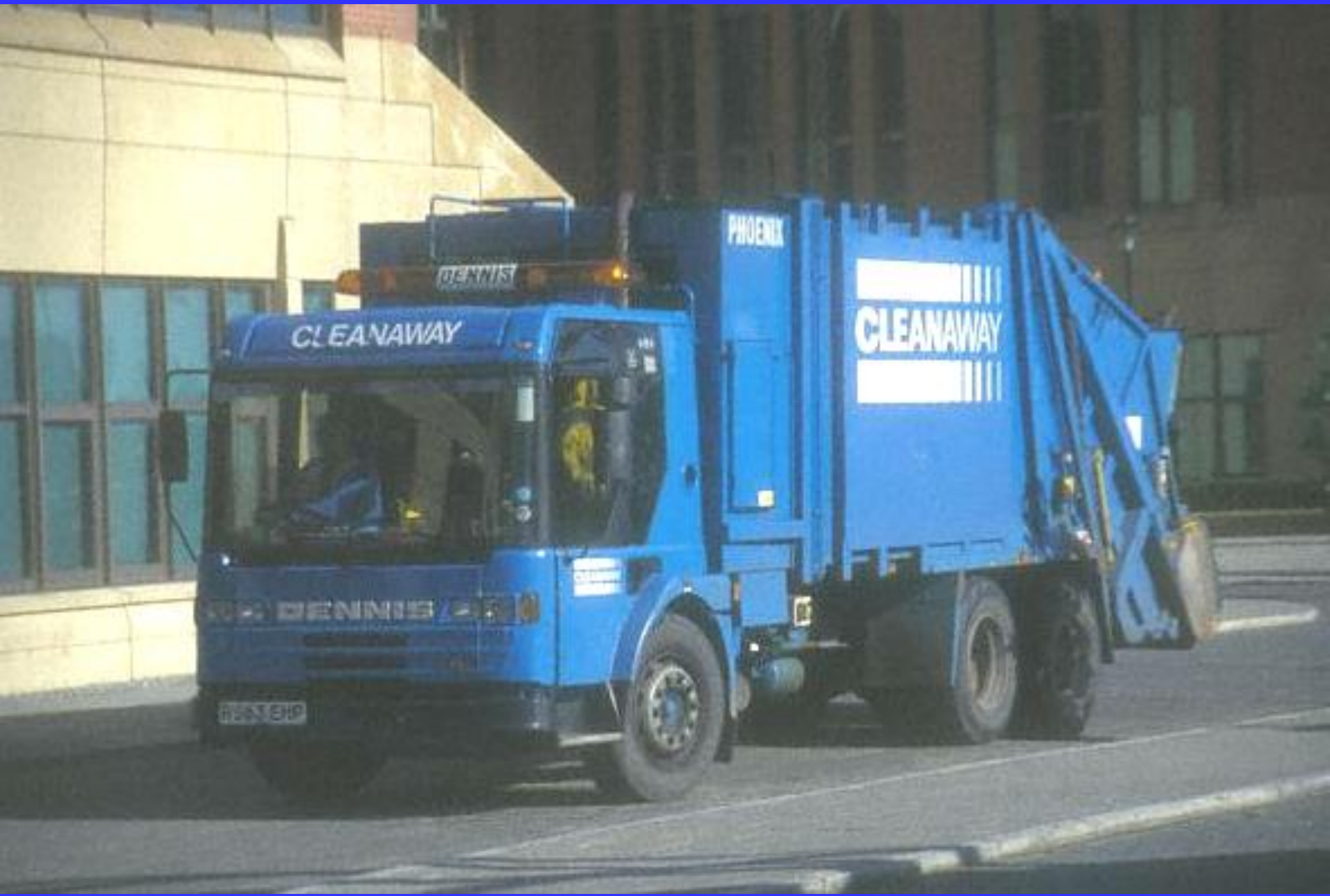
Otomatik yükleme/boşaltma sistemli ve sıkıştırırmalı çöp toplayıcı/taşıyıcı
