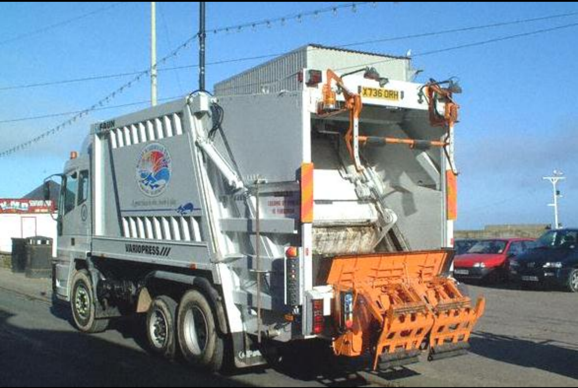
Otomatik yükleme/boşaltma sistemli ve sıkıştırırmalı çöp toplayıcı/taşıyıcı
